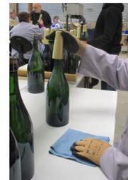
3. On colle la coiffe sur la bouteille à l'aide d'une presse. On passe deux fois dans la presse.
